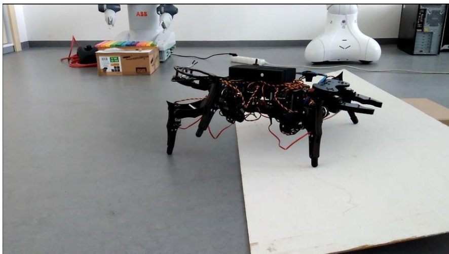
Obrázek 6.1: Chůze robota po nakloněné rovině
